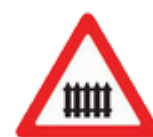
有欄門鐵路平交道
